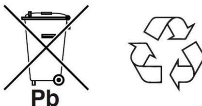
L'etichettatura potrebbe variare in funzione dell'applicazione e della dimensione della batteria. Il produttore, rispettivamente l'importatore delle batterie, è responsabile dell'applicazione dei seguenti simboli, in conformità con gli standard internazionali.
