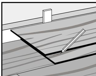
**11** Installa la tavola con il lato tagliato sempre rivolto verso il muro. Usa una barra di trazione per bloccare insieme i bordi lunghi. Non utilizzare la barra di trazione sui bordi corti..
