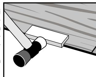
Non picchiettare l'estremità corta in posizione se il giunto lungo non è correttamente innestato, poiché ciò potrebbe danneggiare la linguetta e la scanalatura.
