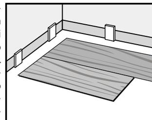
Assicurati che non ci siano spazi vuoti e, se necessario, tocca lungo la lunghezza del bordo della scanalatura utilizzando il martello a superficie morbida e la maschiatura profilata blocco per garantire una perfetta vestibilità.
