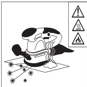
**Produzione di calore e scintille.** Effettuate passate leggere e mantenere lontane le cose infiammabili.
