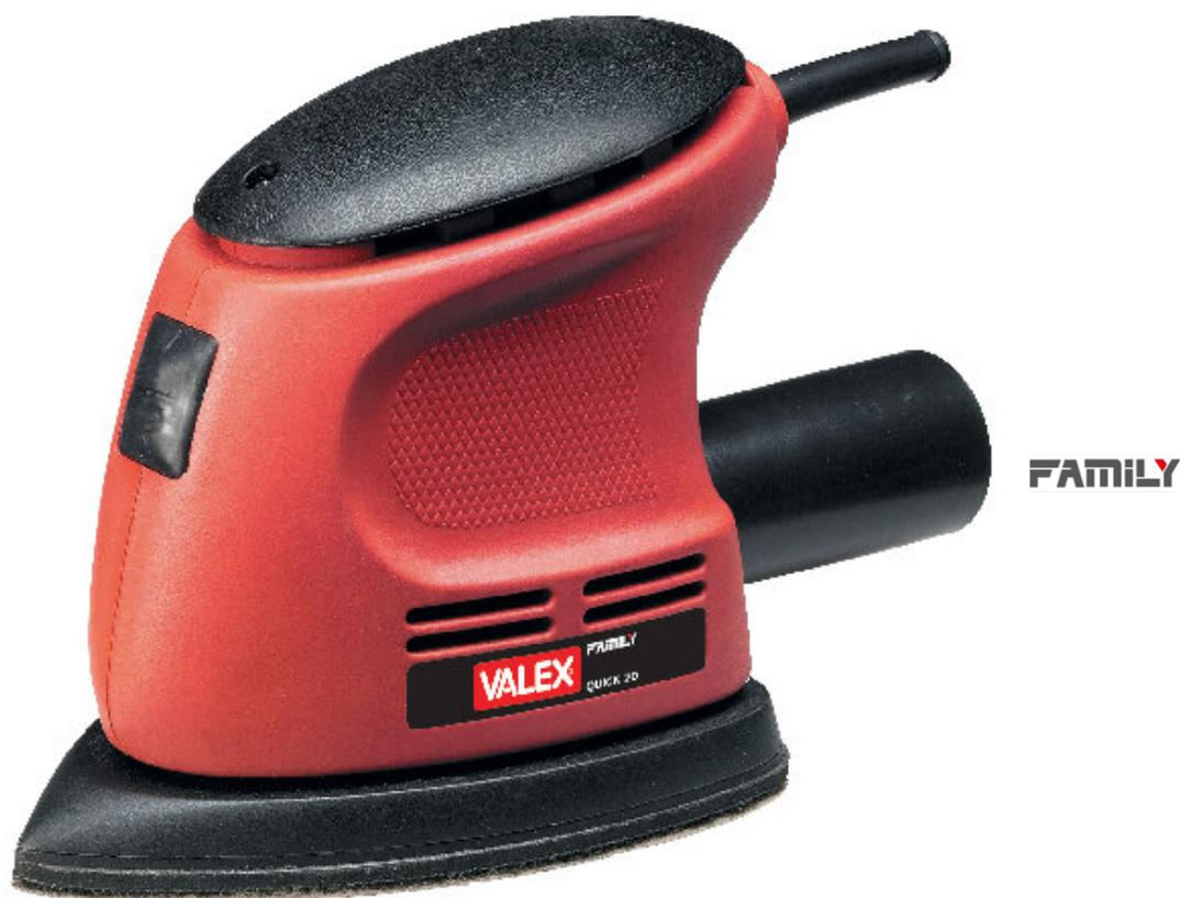
La levigatrice palmare Valex Quick 20 è alimentata da un motore elettrico da 105W e lavora con una velocità a vuoto di 12000 giri/min. Piastra e carta hanno una dimensione di 140x100 mm. L'impugnatura morbida garantisce una presa sicura e confortevole. Il fissaggio della carta avviene tramite sistema a strappo. Quick 20 è predisposta per l'aspirazione delle polveri.
