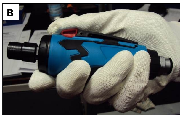
Figura 6 – Avviamento della smerigliatrice.
