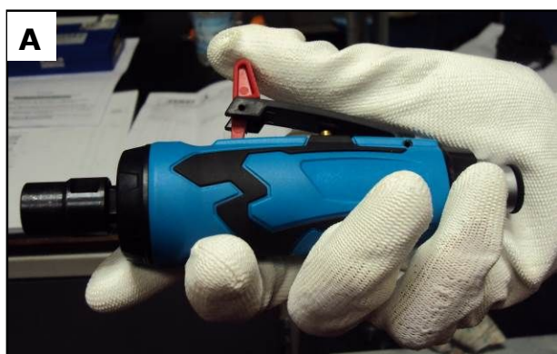
Figura 6 – Avviamento della smerigliatrice.
