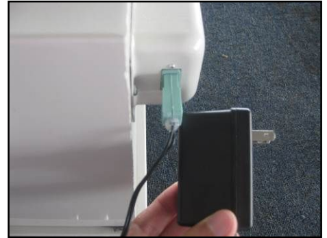
Figura 4 – Connessione del trasformatore.
