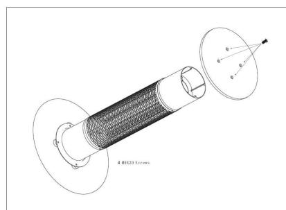
2. Fissare il corpo del riscaldatore al vetro con le 4 viti M5\*8 mm.
